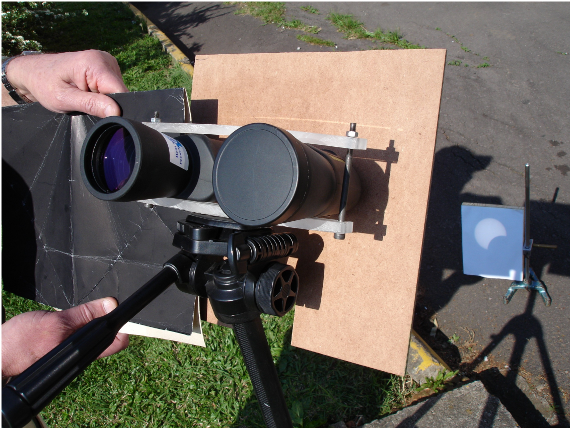
Figura 2. O dispositivo de projeção em uso, durante o eclipse solar ocorrido em 11 de setembro de 2007, em Caxias do Sul, RS, Brasil. Note o dispositivo de fixação do binóculo (apenas um dos lados deste é utilizado), e o anteparo preso a este, de modo que não haja incidência direta da luz do sol no anteparo de projeção (no solo, com a imagem do sol projetada nele). O papel preto que aparece na foto foi empregado para manter toda a região de projeção da imagem do sol na sombra.
