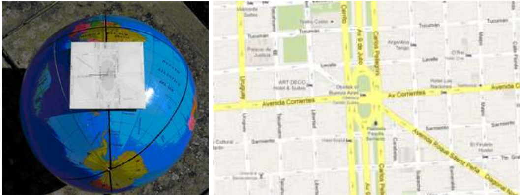
Figura 12: En la foto de la izquierda se ve el dispositivo que permite estudiar las sombras proyectadas por un obelisco en el trabajo con el GTP. En este caso se trata del obelisco de la ciudad de Buenos Aires. El mapa cuadrado, pegado sobre un cartón y apoyado sobre el globo es un recorte del mapa de los alrededores del monumento y el alambre vertical que representa al obelisco tiene las dimensiones adecuadas, en proporción con el mapa (el monumento mide unos 67m de altura). En la foto se ve el polo sur del GTP y el mapa está orientado de manera que el norte quede hacia arriba de la hoja (la misma orientación del mapa de la derecha, que ya apareció en una figura anterior).
