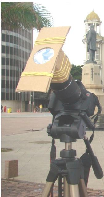
**Figura 1** - Câmera com tripé e Filtro solar à frente da objetiva.
