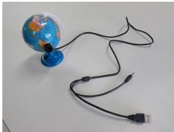
Figura 5 - Modelo terrestre com a câmera webcam e cabo USB acoplados.
