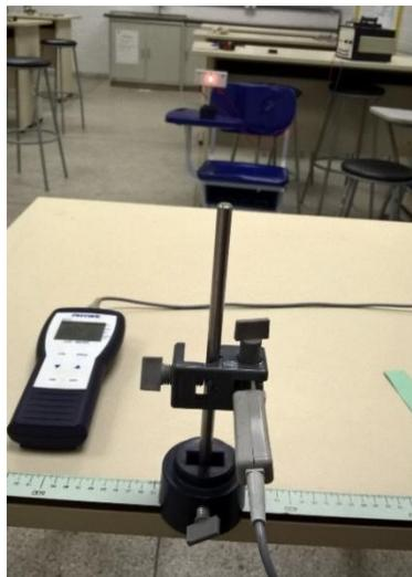
**Figura 8** - Medição do fluxo luminoso para uma distância de 2,10 m.
