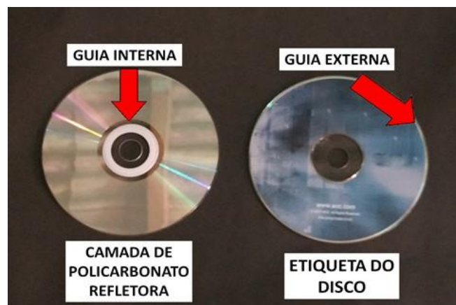
Figura 3 - Partes de um CD, que é o material a ser utilizado para a construção do OA.
