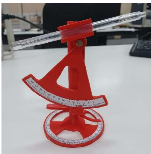
Figura 6 –Fotografia do instrumento produzido em uma impressora 3D com filamento PLA vermelho.
