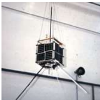
Figura 9. Satélite Dove-OSCAR 17 totalmente construído e aguardando apenas o momento de seu lançamento.
