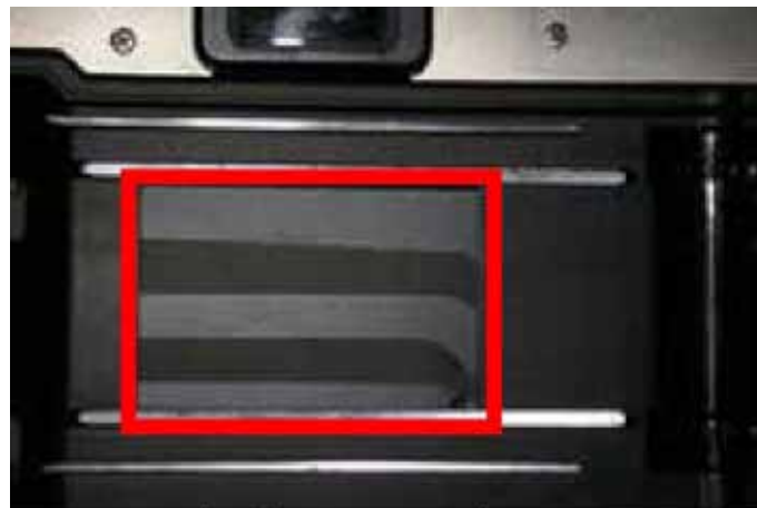
Figura 5. Fotografia indicando o obturador mecânico de plano focal da máquina dentro do retângulo vermelho (fotografia dos autores)
