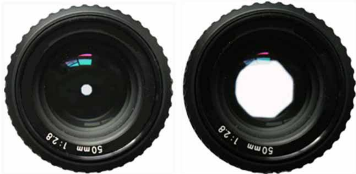
Figura 4. Fotografia comparativa da diferença entre um diafragma fechado (à esquerda) e um diafragma aberto (à direita) em uma lente de máquina fotográfica. [em: http://home.planet.nl/~fotoroos/les1.html ]
