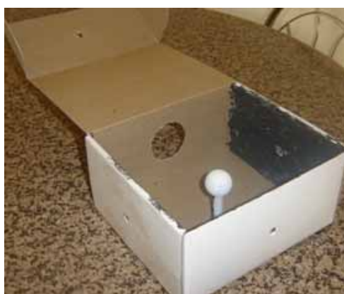
Figura 10. Modelo de uma caixa em que foi usada uma lâmpada incandescente de 15 W ligada à rede elétrica, acionada por um interruptor (painel superior esquerdo). O suporte da lâmpada é de porcelana, e possui um furo bem no centro, pelo qual foi passado o parafuso para prendê-lo à caixa. A lâmpada e o suporte foram envolvidos por uma armação de papelão (painel superior central), internamente revestida de papel alumínio e externamente pintada de preto, visando direcionar o foco da luz. Por segurança, a distância da lâmpada às paredes laterais da armação não deve ser inferior a 2 cm. A bolinha é presa por um fio à tampa da caixa (painel superior direito). Os painéis inferiores mostram imagens da bolinha visualizada através de 3 orifícios diferentes, simulando a Lua nas fases Crescente, Cheia e Minguante.
