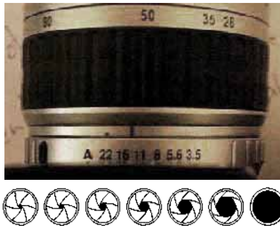
Figura 3. Dispositivo que contém a lente de uma máquina reflex e as ilustrações das diferentes “aberturas” de um diafragma. [em: http://www.astrosurf.com/pedro/tecnica/Camaras.htm ]
