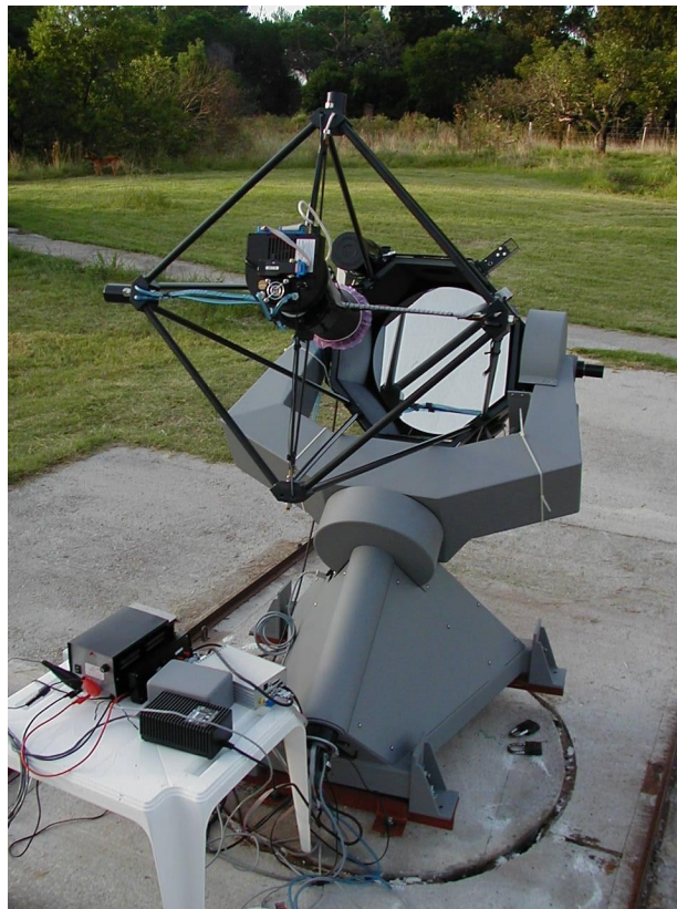
Figura 5. El telescopio reflector Centurion de 46-cm de abertura instalado en el predio del Observatorio Astronómico de Los Molinos (Foto cortesía G. Tancredi).
