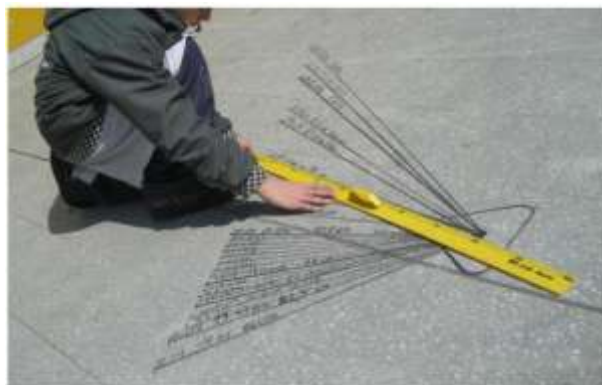
Figura 3: Medición de las sombras a lo largo del día para obtener la meridiana del lugar. Las sombras arrojadas por un gnomon recto y vertical (no presente en la fotografía) fueron marcadas en el patio de la escuela, consignando para cada una de ellas la fecha y la hora. Con el correr de las horas, las sombras cambian gradualmente de longitud y de dirección; la más corta de todas corresponde a aquella sombra que proyecta el gnomon en el mediodía solar, e indica la dirección norte-sur astronómica verdadera (la imagen es cortesía de M. Iglesias).
