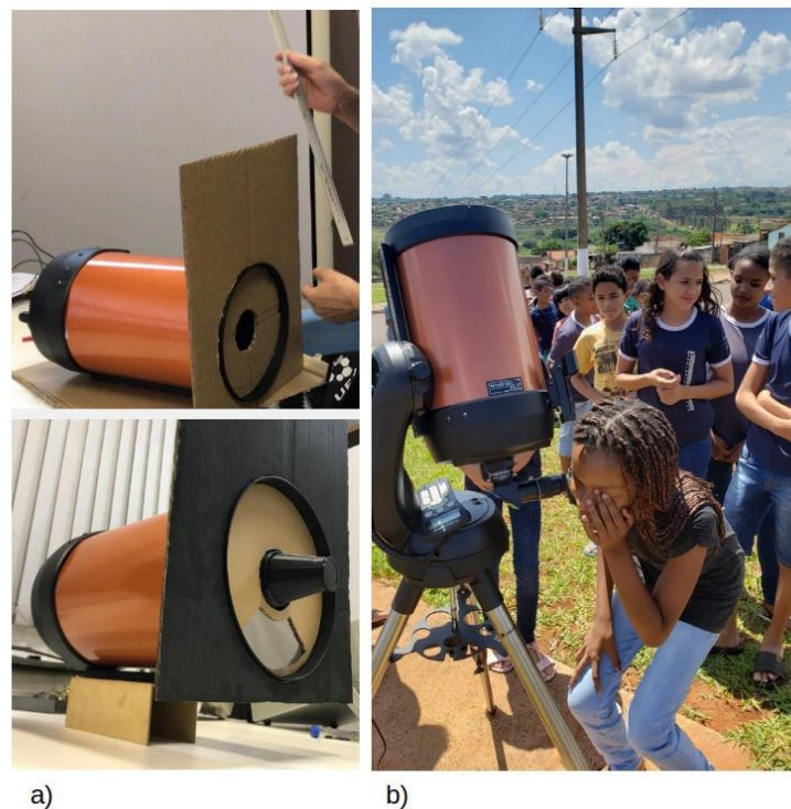
Figura 6 - a) Montagem do filtro solar para permitir a segurança de observação. b) Atividade de observação astronômica (registro do trânsito do planeta Mercúrio, realizada em 11 de novembro de 2019), desenvolvida junto à comunidade escolar no município de Jataí, GO, Brasil.
