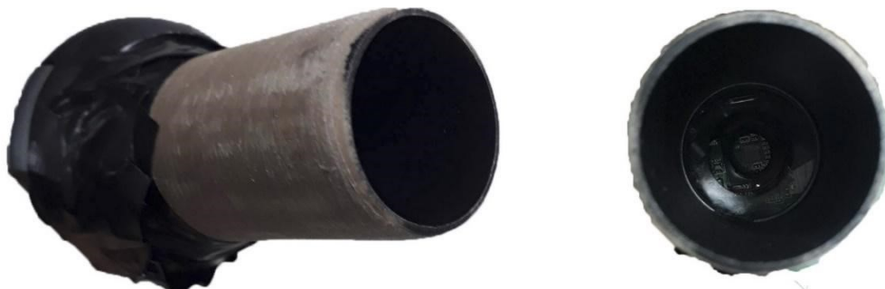
Figura 11 - Webcam Microsoft VX-3000 sem sua ocular (sensor exposto) e com suporte de acoplamento (cano PVC \frac{3}{4} ).
