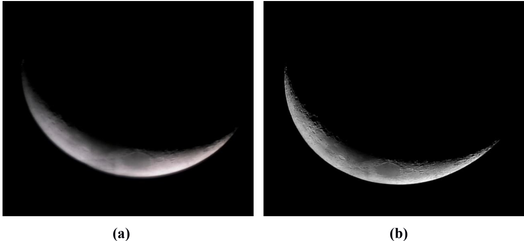
Figura 27 - Lua capturada com webcam Microsoft LifeCam VX-3000 , sem filtro lunar, mosaico de 7 imagens processadas, Contrast=115, Hue=173, Saturation=32, Sharpness=589, Gamma=99, White Balance=100 , 18/05/18, (a) Lua sem processamento (b) Lua processada. Fonte: os autores.
