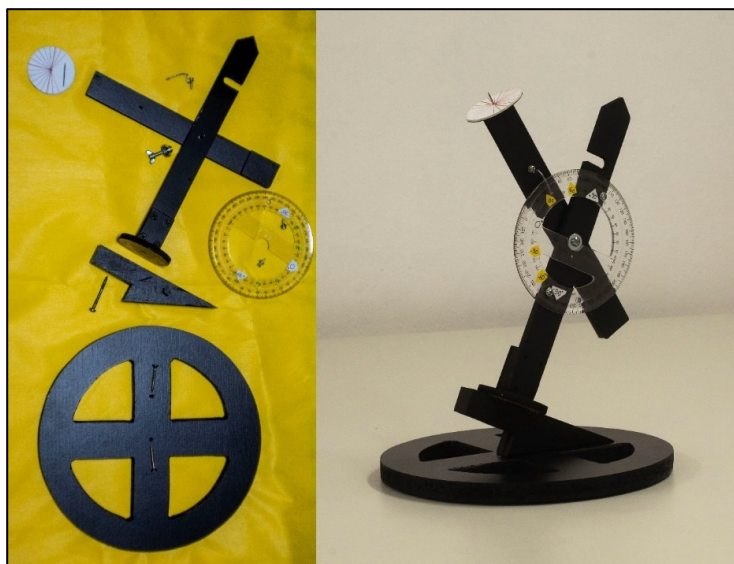
Figura 3 - Imagem da esquerda: modelo desmontado. À direita, o modelo montado e ajustado para uma latitude de +30^\circ . O entalhe na peça de extremidade com ponta, que corresponde ao eixo da Terra, permite o ajuste do OMDASG na latitude de +90^\circ (Polo Norte). O disco impede que o ajuste de -90^\circ (o gnômon no Polo Sul) seja feito.
