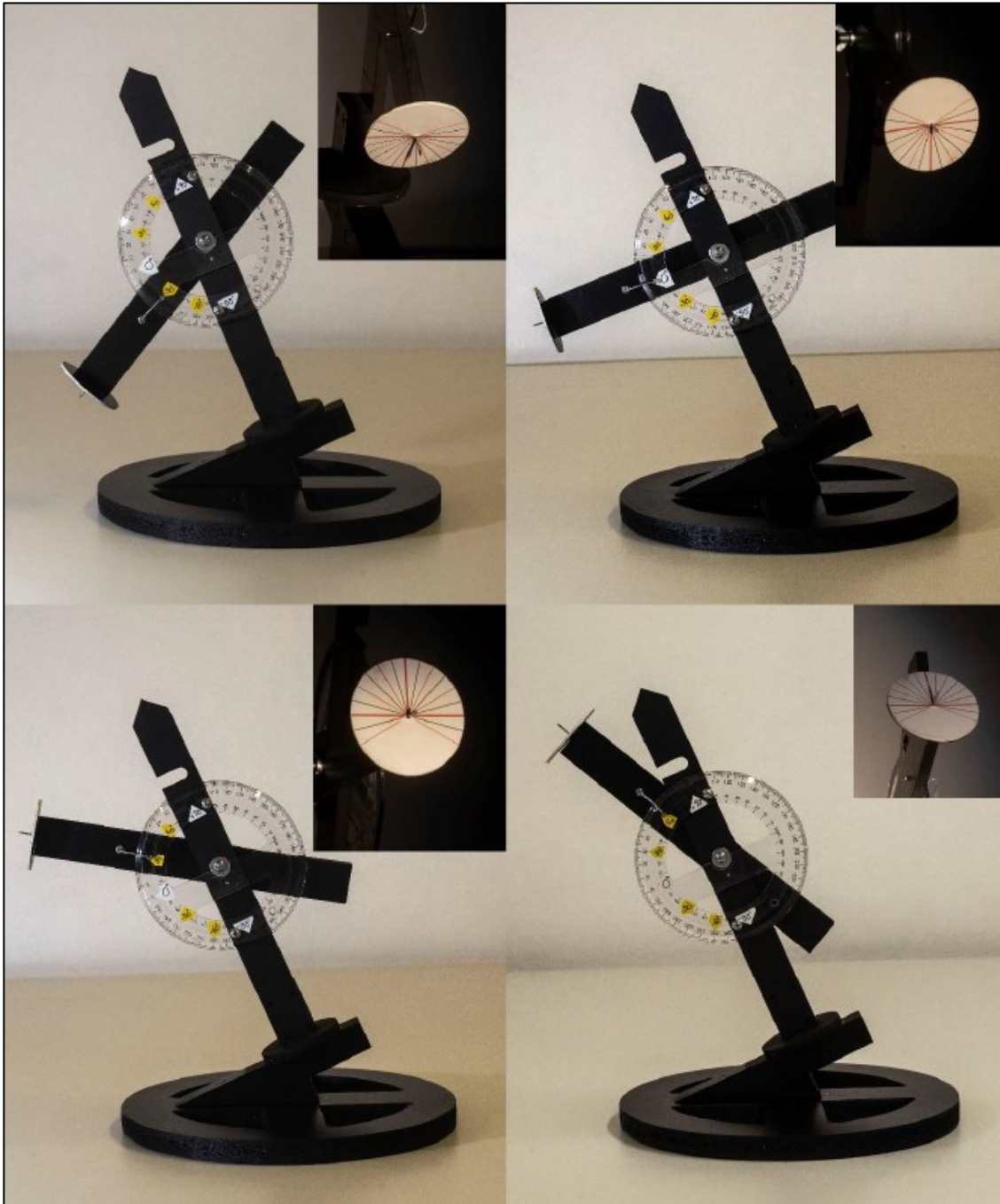
Figura 8 - A sombra de um gnômon, numa mesma longitude, na ocasião em que o Sol está cruzando ou se encontra na direção do meridiano desta longitude, isto é, está aproximadamente ao meio dia (ou meio dia solar verdadeiro de fato), mais alto no céu local em diferentes latitudes: -30^\circ (imagem superior, à esquerda), 0^\circ (imagem superior, direita), +30^\circ (imagem inferior, à esquerda) e +60^\circ (imagem inferior, à direita).
