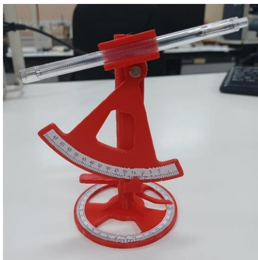
Figura 6 –Fotografia do instrumento produzido em uma impressora 3D com filamento PLA vermelho. Fonte – autoria própria.
